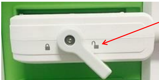
Фигура 29: Копче на конектора на трансдюсера в отключено положение
