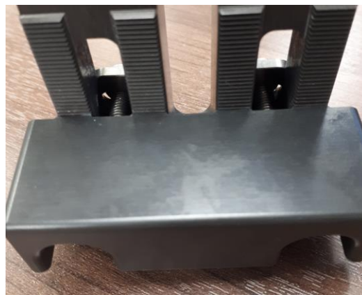
Фигура 38: Центриран държач на шаблонната мрежа
