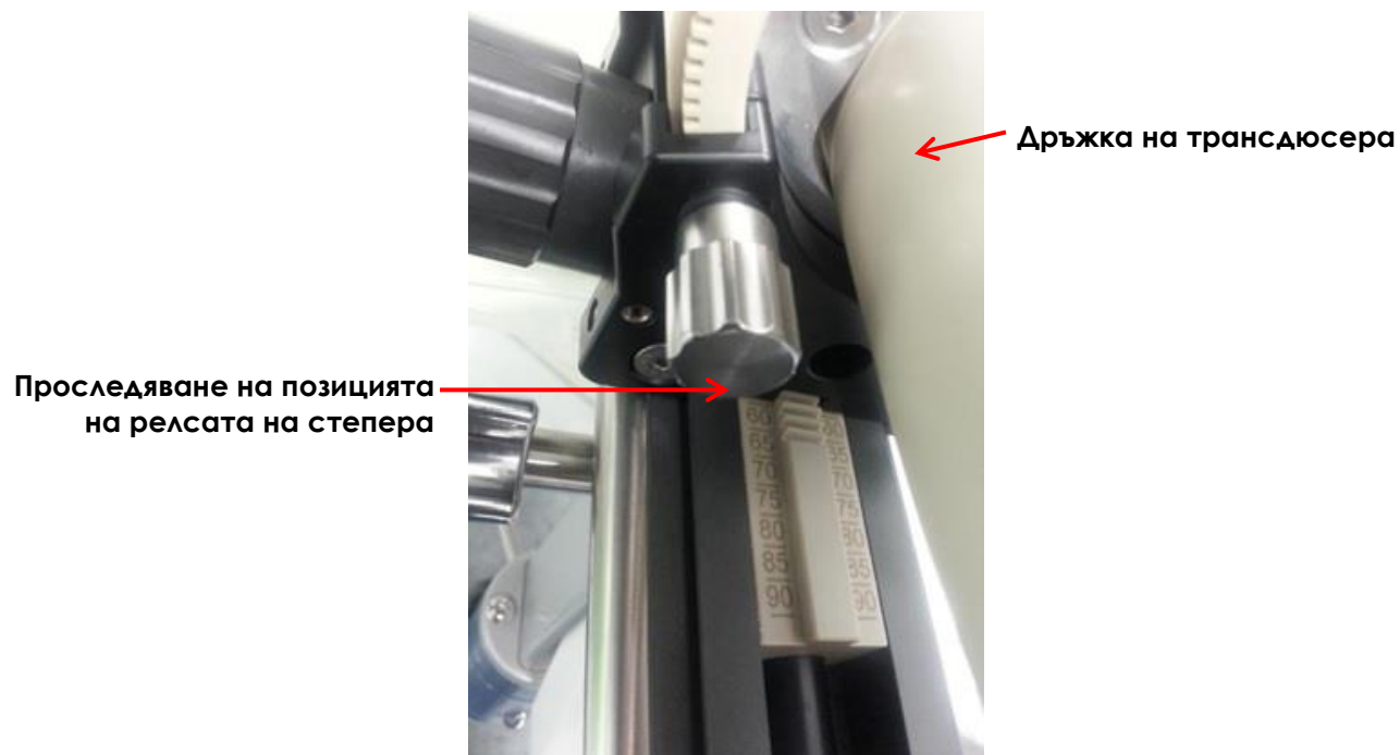
Фигура 40: Проследяване на позицията на релсата на степера
