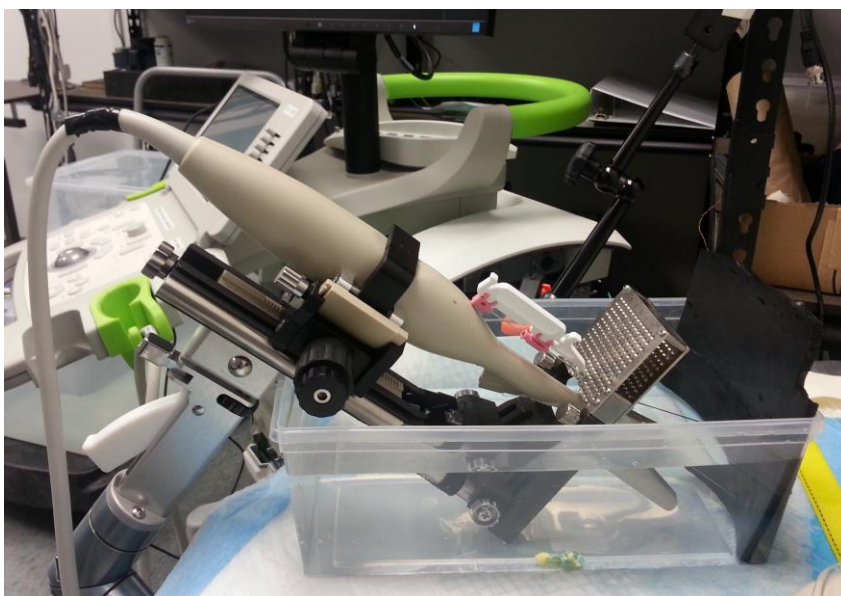
Фигура 41: Трансдюсер и трансперинеален степер във водна баня
