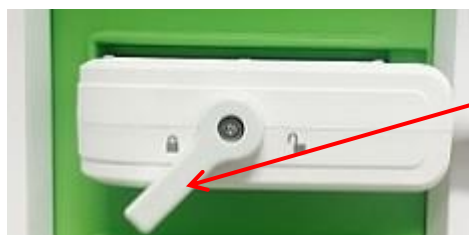
Фигура 28: Ориентация на конектора на трансдюсера
